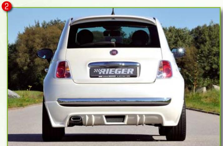
Heckschürzenansatz für Endrohr links und links/rechts
